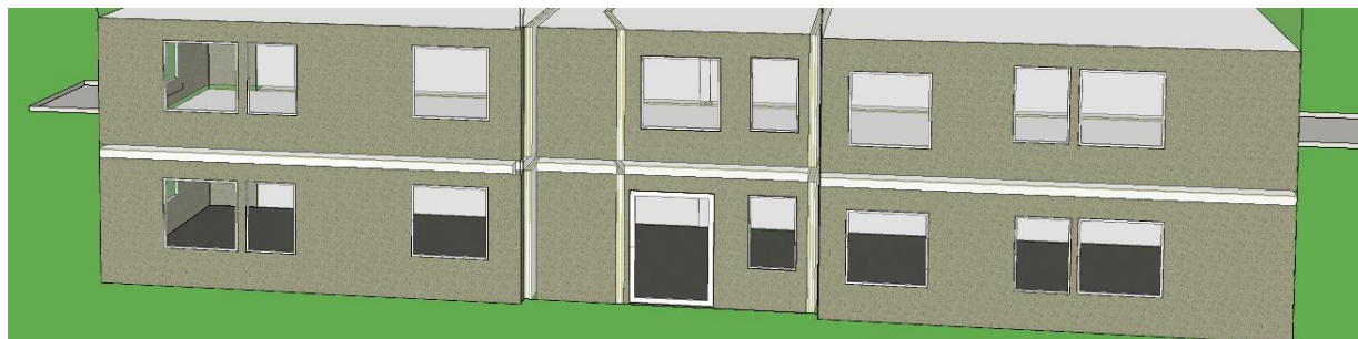
Figur 3.18 Exempel på fasad av där det blir många löpmeter köldbryggor.
